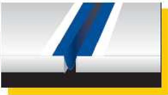
Posizionamento ad omega del nastro gommato all'interno del giunto di dilatazione
