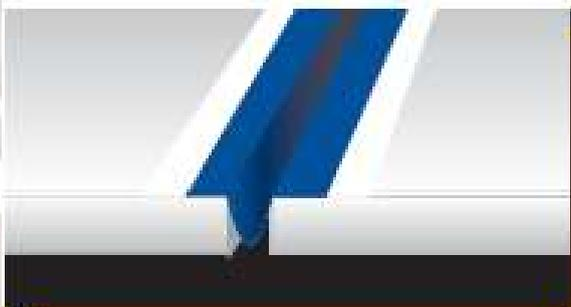
Positionnement oméga de la bande en caoutchouc dans le joint de dilatation
